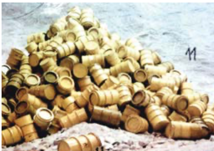
Aus Strahlenschutzgründen abgeworfene Fässer in einer Einlagerungskammer der Schachanlage ASSE II.
